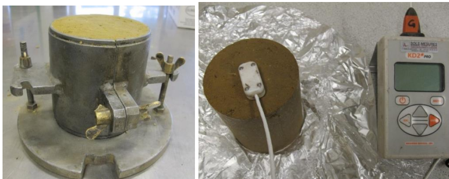
Figure 2. a) Sol (Limon Plaisir) compacté dans un moule Proctor, b) Mesure de la conductivité thermique par la technique du fil chauffant.
